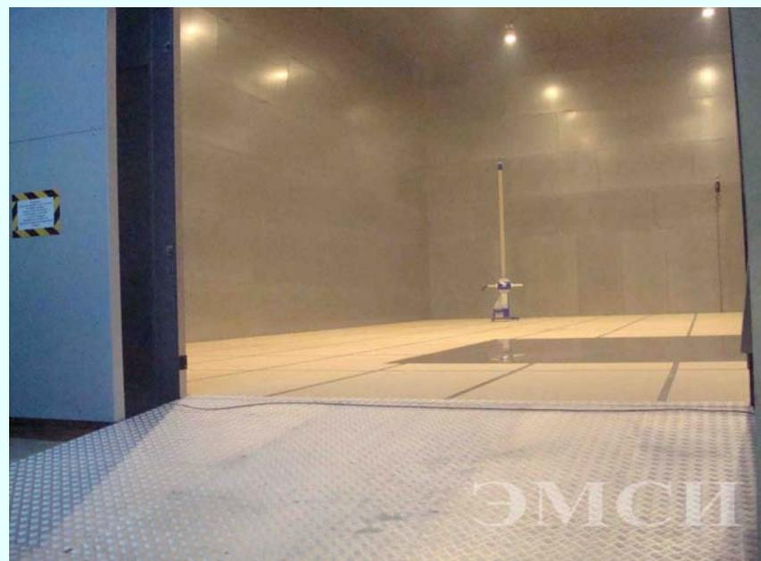
Все типы дверей имеют концевые выключатели для сигнализации полного закрытия двери.
